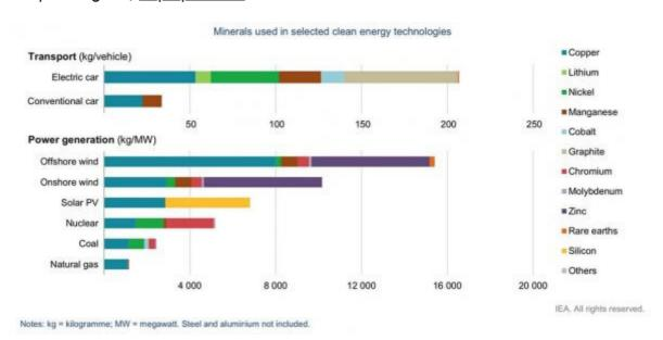
Quantité de métaux et minéraux utilisés en fonction des technologies, en kilogramme par véhicule et en kilogramme par MW produit. Source AIE
